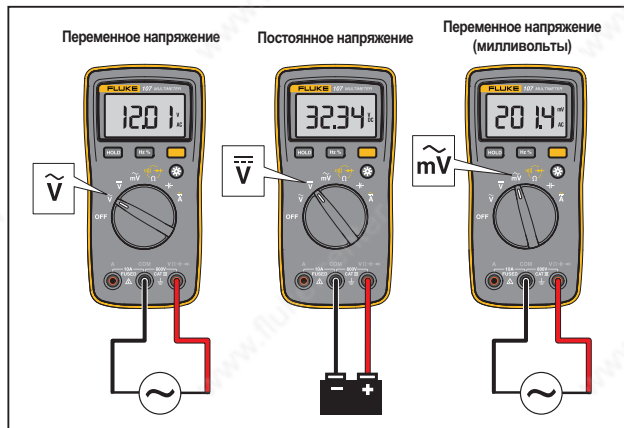
Рис. 2. Измерение переменного (AC) и постоянного (DC) напряжения
